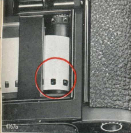
Die - matte - Schichtseite muß dem Objektiv bzw. dem Schlitzverschluß zugewendet sein; bei der Aufwickelspule muß diese Schichtseite nach außen liegen. Die Filmkante muß parallel zu der Filmführung liegen, und die Zähne der Transportwalze müssen bei vorsichtigem Betätigen des Schnell-schalthebels in die Perforationslöcher des Films eingreifen. Nun schließen Sie die Kamerarückwand, setzen den Boden-deckel wieder auf und verriegeln ihn.
