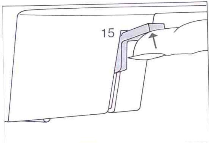
Beim Einlegen extrem dicker Stofflagen Hebel 15 höher anheben.
