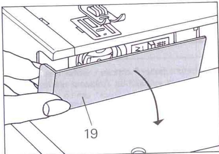
Verschlußklappe 19 nach unten öffnen.
