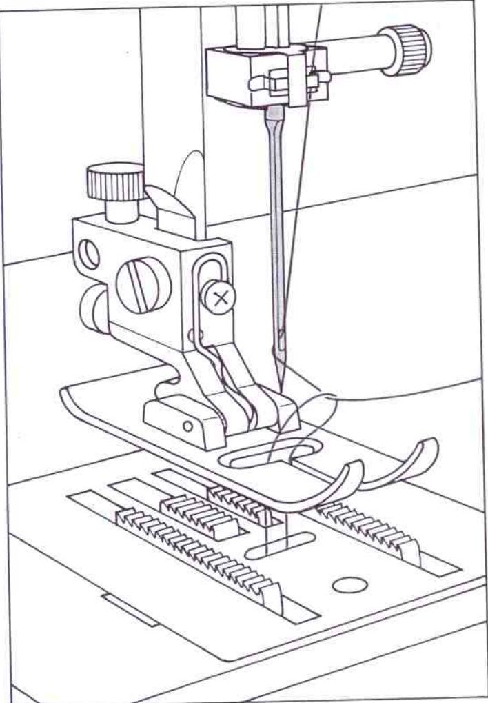
**Unterfaden heraufholen:** Oberfaden festhalten. Handrad nach vorn drehen und einen Stich nähen bis Nadel und Fadenhebel wieder oben stehen. Mit dem Oberfaden den Unterfaden nach oben ziehen.
