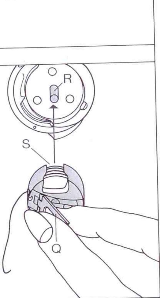
**Spulenkapsel einsetzen:** ● *Hauptschalter 8 ausschalten.* Klappe Q anheben und die Kapsel bis zum Anschlag auf Stift R schieben. Ausschnitt S muß dabei nach oben zeigen.
