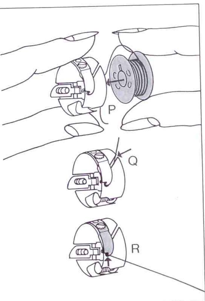
**Spule einlegen P** (Faden nach hinten). Den Faden in den Schlitz Q und bis zur Öffnung R ziehen.
