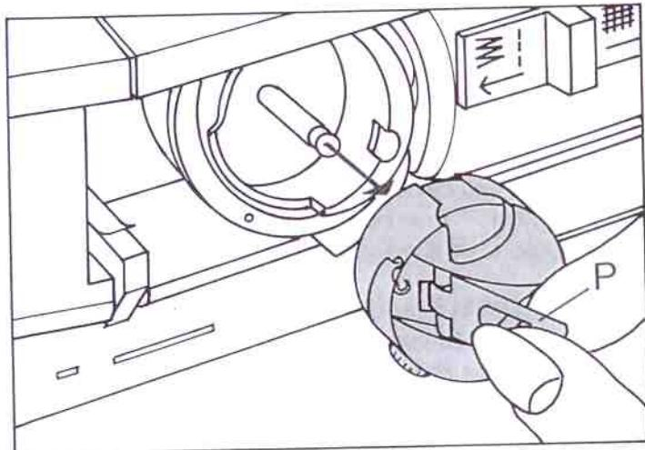
● **Hauptschalter 8 ausschalten.** Klappe P anheben und die Spulenkapsel herausziehen.
