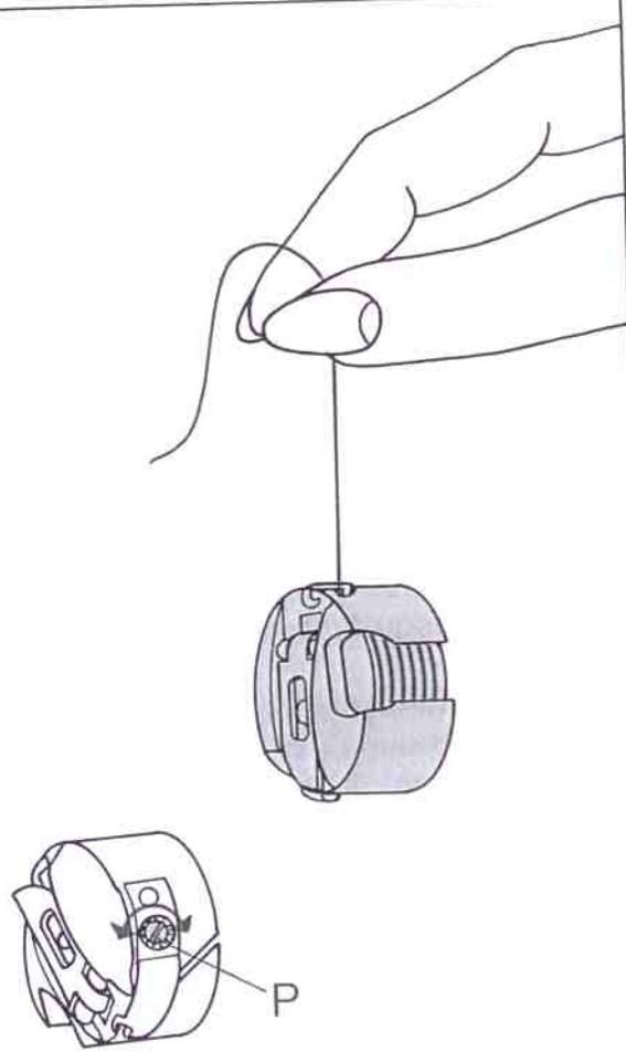
**Unterfadenspannung prüfen:** Kapsel leicht ruckartig aufwärtsbewegen. Sie muß stufenweise niedersinken. (Einstellschraube P nach links drehen = loser, nach rechts drehen = fester).
