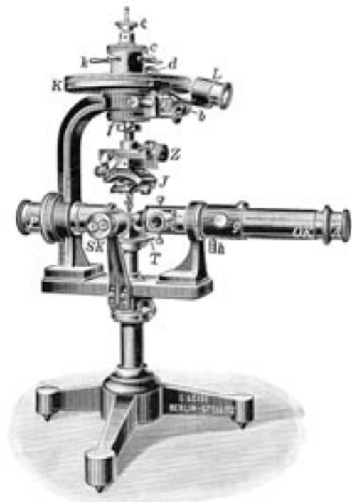
Mynd 29-5. Að ofan t.v.: Tæki til mælinga á brotstuðlum kristalla, frá C. Zeiss (Czapski 1891b). T.h.: Svipað tæki C. Kleins (1902) framleitt af R. Fuess. Mynd úr Duparc og Pearce (1907), Nicol-prismu eru við Np og Na. Að neðan t.v.: Fjölhæft tæki (Universalapparat, Viola 1897) til kristalrannsóknna. T.h.: Tæki E.A. Wülfings (1898) til mælinga á áshornum tvíása kristalla, Nicol-prismu eru við P og A. Framleitt af C. Leiss (1925).
