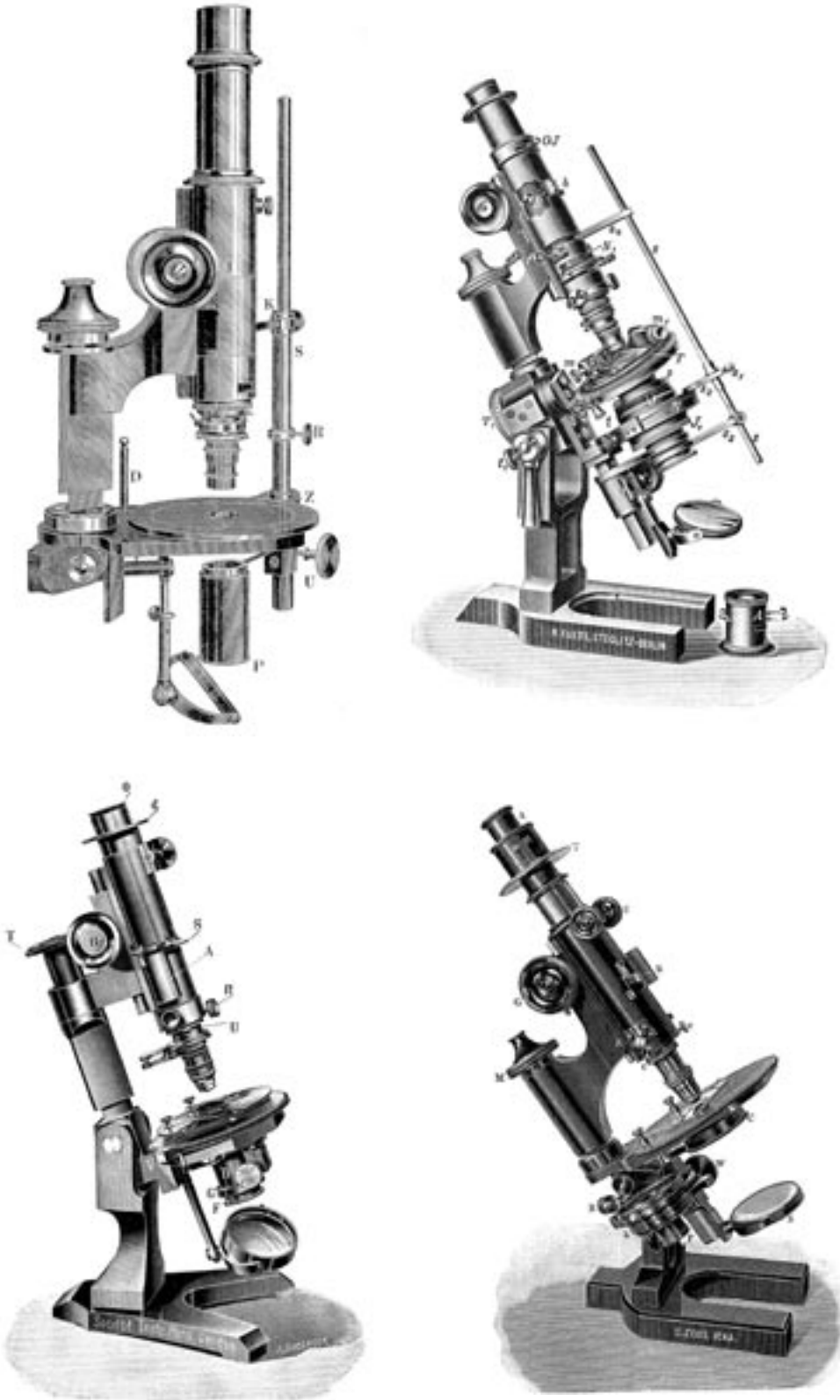
Mynd 29-2. Smásjár, um 1900. Að ofan t.v.: Smásjá Sommerfeldts (1904), ein þeirra fyrstu þar sem bæði skautara- og greiniprismum var snúið samtímis með stöng. T.h.: Smásjá hönnuð af V. de Souza-Brandao 1903 og framleidd frá 1910 af R. Fuess. Mynd úr Johannsen (1914). Að neðan t.v.: Smásjá framleidd af Sociéte Genevoise. Mynd úr Duparc og Pearce (1907). T.h.: Smásjá framleidd af C. Zeiss, mynd úr Czapski (1891a).
